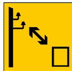
La distance de sécurité est le rayon d'un cercle ayant comme axe la ligne électrique. Aucun élément des engins ne doit pénétrer dans ce volume.
