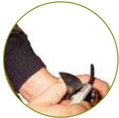
Le mouvement s'adapte à la courbure de la lame afin de ne pas la déformer.
